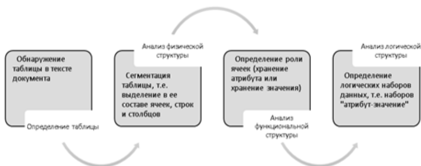
Последовательность этапов извлечения данных из таблиц
