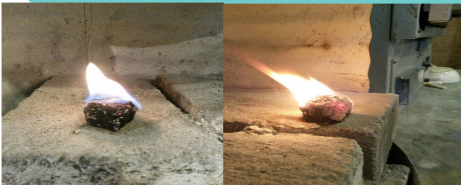
Горение брикетов из Ой-Карагайских углей с вяжущим полиэтилентерефталатом
