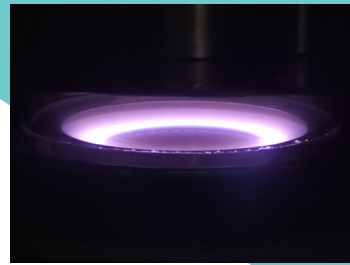
Рис 2. Плазма разряда ионов аргона в магнетроне используемая для синтеза алмазоподобных пленок модифицированных наночастицами различных металлов
