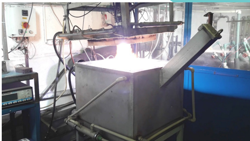
Плазмохимический реактор с действующим электродуговым плазмотроном
